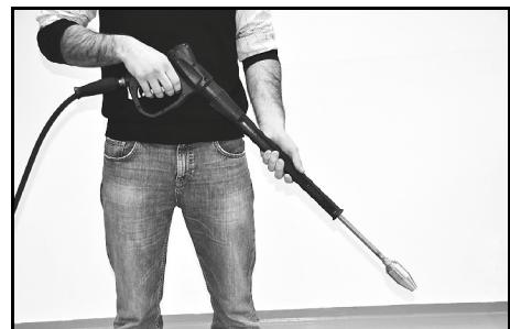
2. Start rengøringsarbejdet med en dyseafstand på 20 til 30 cm. Du finder den bedste dyseafstand ved at langsomt nærme dig rengøringsgenstanden.
