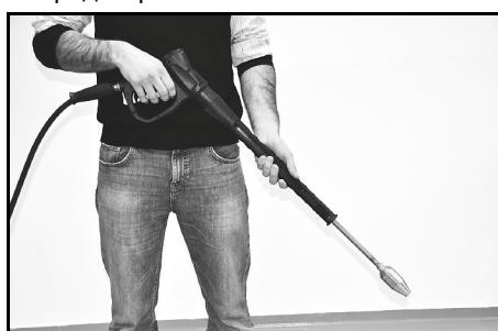
2. Начинать мойку на расстоянии 20-30 см между соплом и очищаемым объектом. Определить оптимальное расстояние, медленно приближаясь к очищаемому объекту.
