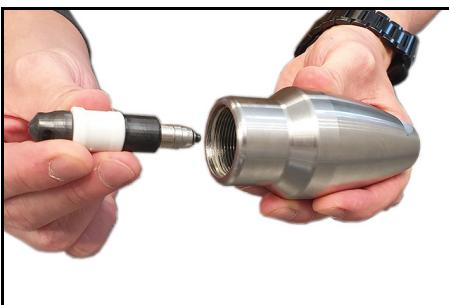
9. Смазать резьбу крышки привода консистентной смазкой (номер детали 6.288-079.0).
