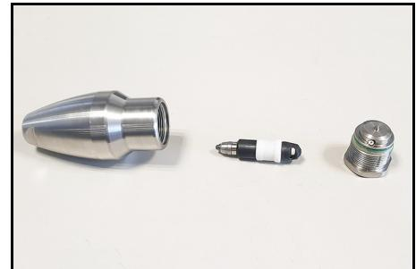
4. Извадете гнездото със специален инструмент (номер на част 6.025-233.0).
