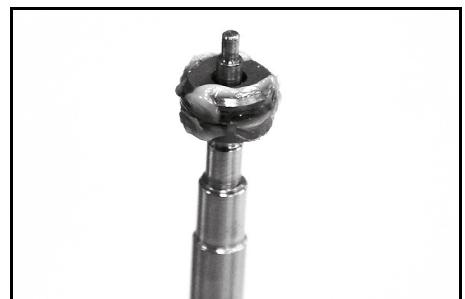
6. Смазать гнездо силиконовой смазкой (номер детали 6.288-044.0).
