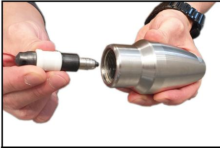
9. Nasmarować gwint pokrywy napędowej smarem (numer części 6.288-079.0).
