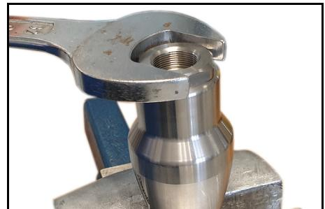
3. Снять ротор.
