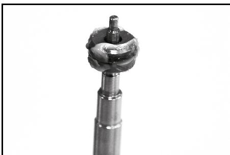
6. Graisser le siège avec de la graisse de silicone (référence de pièce 6.288-044.0).
