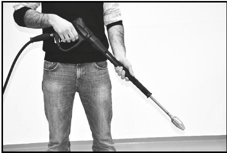
2. Aloita puhdistustyö suuttimen etäisyydellä 20–30 cm. Määritä paras suuttimen etäisyys lähestymällä hitaasti puhdistettavaa kohdetta.
