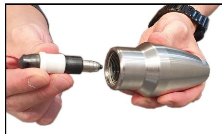
9. Das Gewinde des Treibdeckels mit Fett (Teilenummer 6.288-079.0) einfetten.
