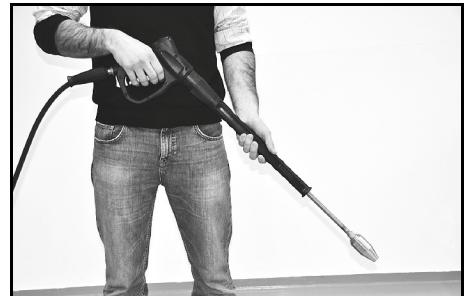
2. Commencer le travail de nettoyage avec une distance entre les buses de 20 à 30 cm. Déterminer la meilleure distance entre les buses en approchant lentement de l'objet à nettoyer.
