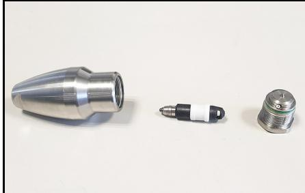
4. Den Sitz mit dem Spezialwerkzeug (Teilenummer 6.025-233.0) herausdrücken.
