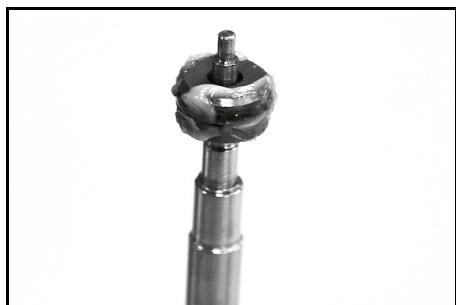
6. Lubrificar o assento com lubrificante de silicone (referência 6.288-044.0).
