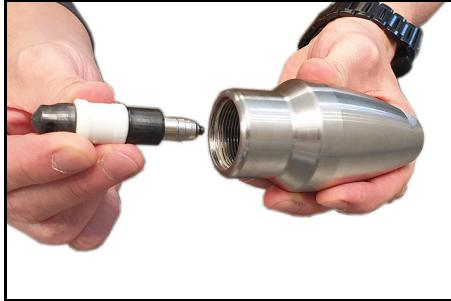
9. 用油脂（零件号 6.288-079.0）涂抹驱动盖的螺纹。
