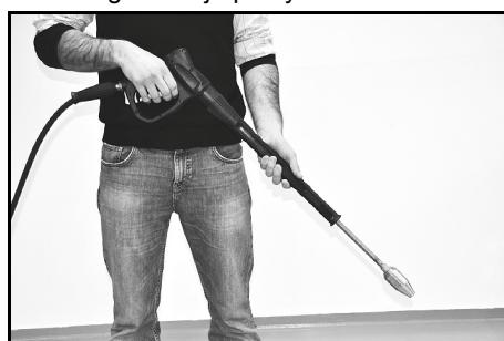
2. Start rengjøringsarbeidet med en dyseavstand på 20 til 30 cm. Bestem den beste dyseavstanden ved å nærme deg rengjøringsobjektet sakte.
